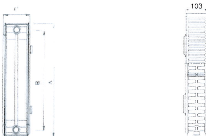
Sl. 1. Dimenzije čeličnog panelnog radijatora model SANICA 22 (PKKP)
